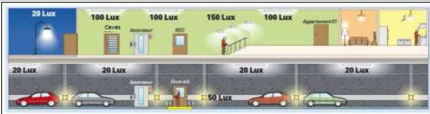
Valeurs d'éclairage des parties communes
